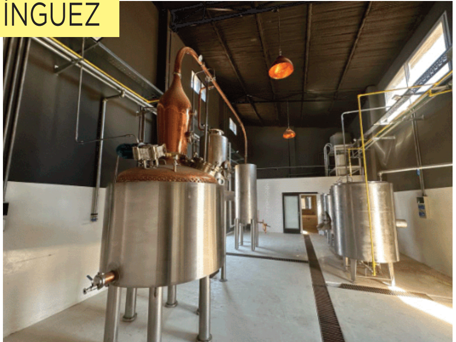
Los alambiques son parte fundamental del proceso de elaboración de whisky.
